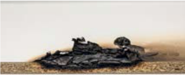
Sezione di pannello nobilitato NOFIRE P2 CE dopo 30 minuti di combustione. Cross-section Melamine Face Chipboard NOFIRE P2 CE after 30 minutes of burning.
