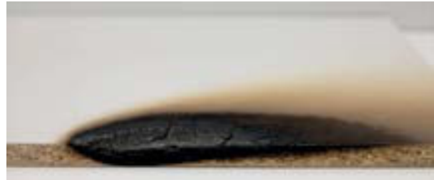
Sezione di pannello nobilitato E1 P2 dopo 30 minuti di combustione. Melamine Faced Chipboard E1 P2 after 30 minutes of burning.
